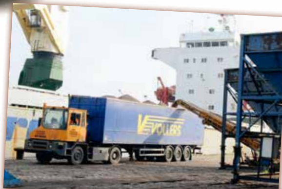
Bulktrailers worden geladen via kranen en transportbanden.
