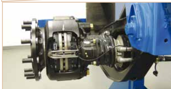
Een vrachtwagen kan trommelremmen (boven) of schijfremmen (onder) hebben.
